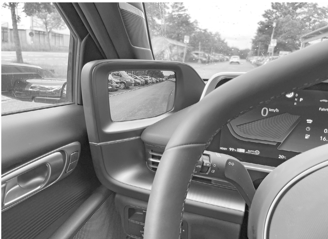
Virtuelle Außenspiegel sollen aufgrund der kleineren Kameras den Luftwiderstand verringern, gleichzeitig kann damit der tote Winkel minimiert werden. Allerdings sind die Displays in der Türverkleidung oft ungünstig positioniert.
